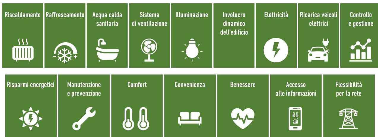
Figura 12. Struttura della metodologia di calcolo del metodo Smart Readiness Indicator , con i 9 domini tecnici e i 7 criteri d'impatto. (Commissione Europea, 2020)
