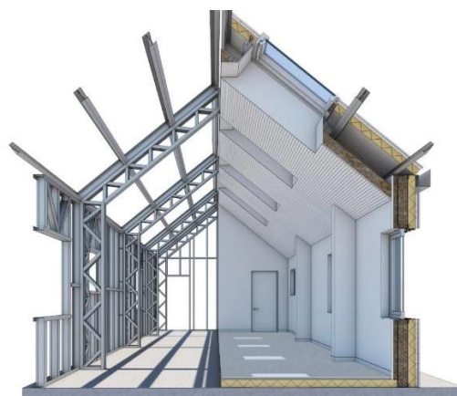
Figura 27. Vista tridimensionale di strutture in carpenteria metallica pesante e rivestimenti di facciata a secco (a sinistra, PICHLER projects Srl) e sezione prospettica di un edificio con tecnologia S/R in Light Steel Frame (a destra, Manni Green Tech Srl)
